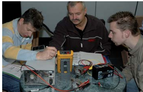
Experiment om remenergie te regenereren. Op tafel twee gelijkstroommotortjes met een asje er tussen, een voeding, een scoop en een batterij.
