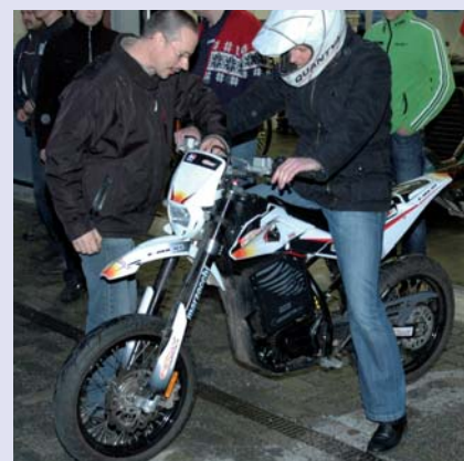
Met zijn gelijkstroommotor is de Quantiya-crossmotor een uitzondering. Nadeel, de borstels zijn slijtage-delen.
